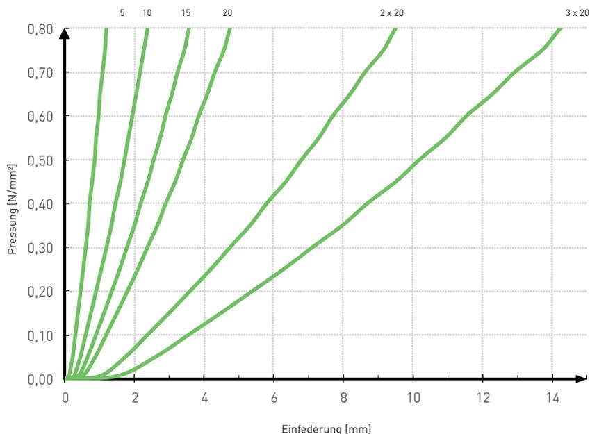
Aufgezeichnet wurde jeweils die 3. Belastung, Prüfung bei Raumtemperatur zwischen ebenen Stahlplatten. Prüfung in Anlehnung an DIN EN 826:
