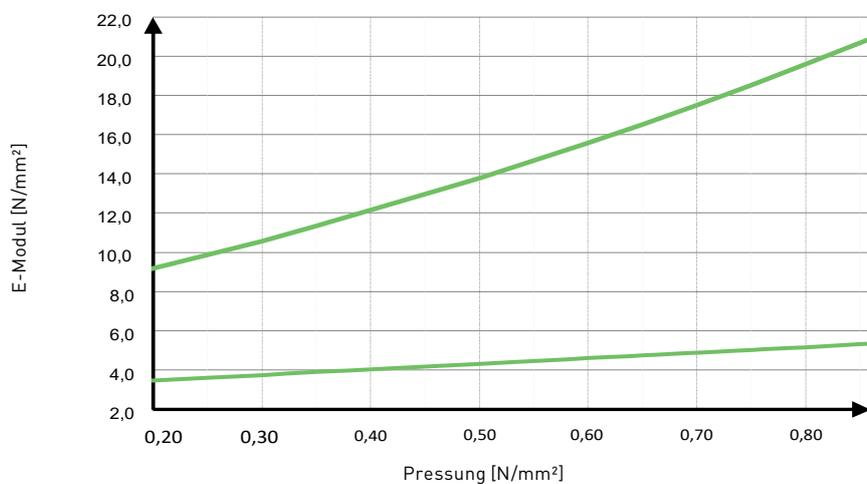
Dynamische Prüfung: harmonische Anregung mit einer Amplitude von  $\pm 0,25 \text{ mm}$  bei  $10 \text{ Hz}$  Messung in Anlehnung an DIN 53513:
