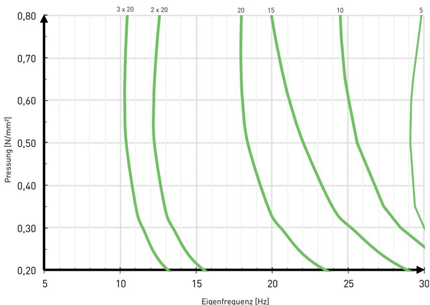
Eigenfrequenz des Systems bestehend aus einer kompakten Masse und einer elastischen Lagerung aus SPEBA® DAMTEC® vibra auf starrem Untergrund:
