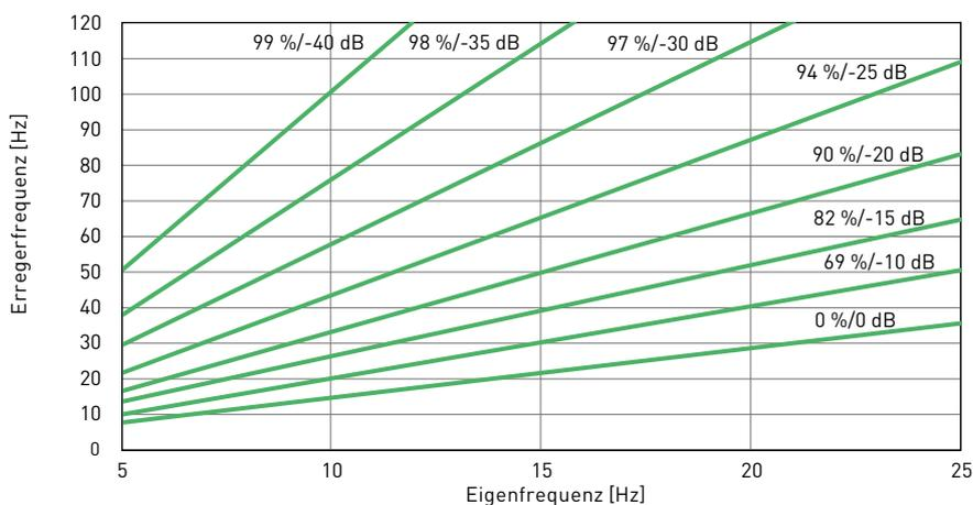
Dargestellt ist die Isolierwirkung für einen Ein-Massen-Schwinger auf starrem Untergrund mit SPEBA® DAMTEC® vibra auf starrem Untergrund:
