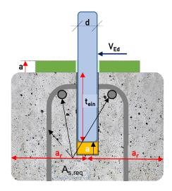
Bild AB1: Lasteinleitung von Horizontalkräften über einen einseitig eingespannten runden Querkraftdorn bei unbewehrtem Beton.
