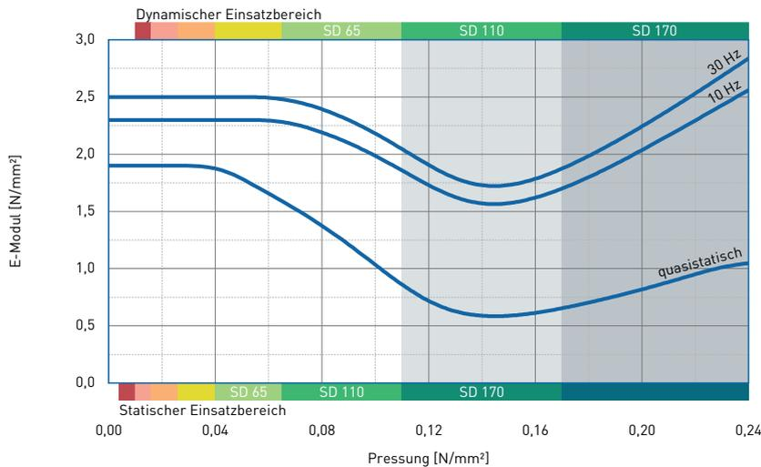
Dynamische Prüfung: harmonische Anregung mit einer Amplitude von  $\pm 0,22$  mm bei 10 Hz und  $\pm 0,08$  mm bei 30 Hz
