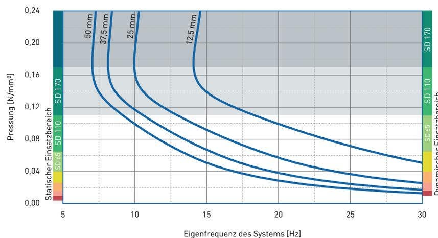
Eigenfrequenz eines Systems, bestehend aus einer kompakten Masse und einer elastischen Lagerung aus SPEBA® vibrafoam 110 auf starrem Untergrund.
