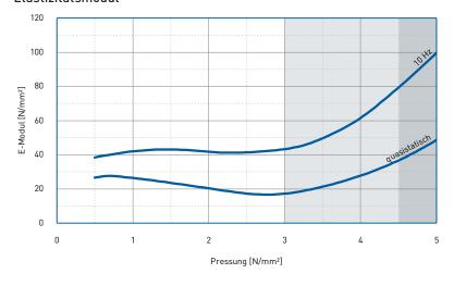
Dynamische Prüfung: harmonische Anregung mit einer Amplitude von ± 0,11 mm bei 10 Hz und ± 0,04 mm bei 30 Hz
