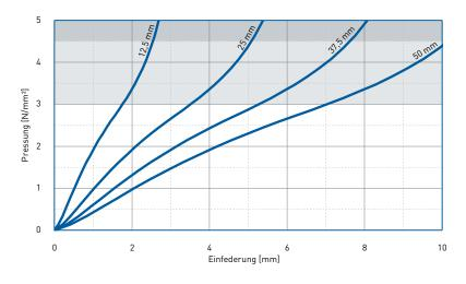
Aufgezeichnet wurde jeweils die 3. Belastung, Prüfung bei Raumtemperatur zwischen ebenen Stahlplatten.
