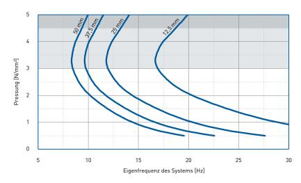
Eigenfrequenz eines Systems, bestehend aus einer kompakten Masse und einer elastischen Lagerung aus  $\ensuremath{\mathsf{SPEBA}^{\$}}$  vibradyn HL 3000 auf starrem Untergrund.
