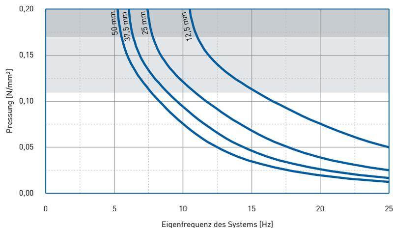
Eigenfrequenz eines Systems, bestehend aus einer kompakten Masse und einer elastischen Lagerung aus SPEBA® vibradyn 110 auf starrem Untergrund.
