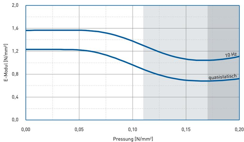
Dynamische Prüfung: harmonische Anregung mit einer Amplitude von  $\pm 0,11$  mm bei 10 Hz und  $\pm 0,04$  mm bei 30 Hz
