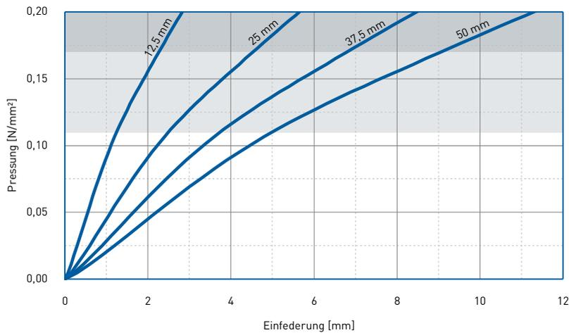
Aufgezeichnet wurde jeweils die 3. Belastung, Prüfung bei Raumtemperatur zwischen ebenen Stahlplatten.
