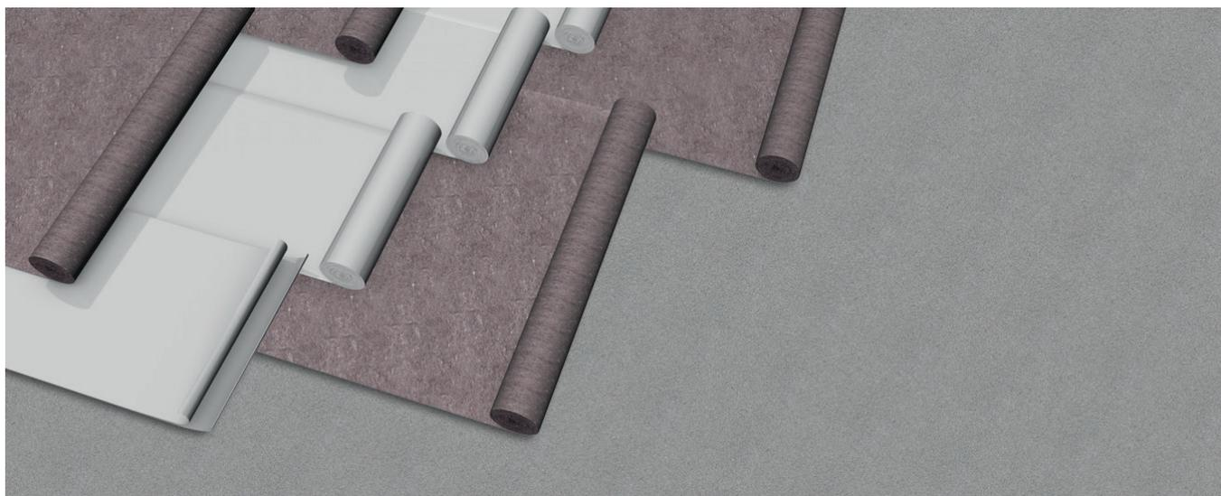
SPEBA® Großflächen-Gleitlager der Serie F 5/510 sind spezielle Gleitlager für z.B. Schwimmbecken, Eislaufbahnen/Rollschuhbahnen, Tanktassen/Betonwannen und andere Flächenbetone. Aufgrund von Temperatureinwirkungen, Kriech- und Schwindprozessen oder Bewegungen im Untergrund entstehen Spannungen zwischen Erdreich und Bauwerk. Eine Bewegungsfuge (ausgebildet durch SPEBA® Großflächen-Gleitlager F5 mit SPEBA-Dur beschichtet) verhindert Rißbildungen durch diese Spannungen.
